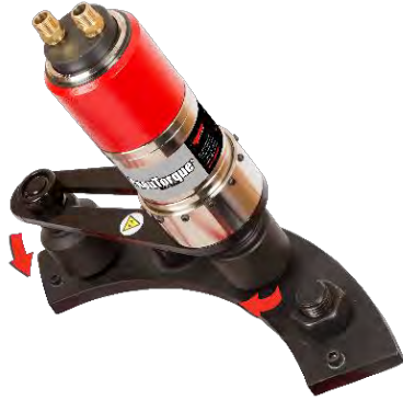
KUVA 5 – Tuki myötäpäivään (FWD) käytettäessä
