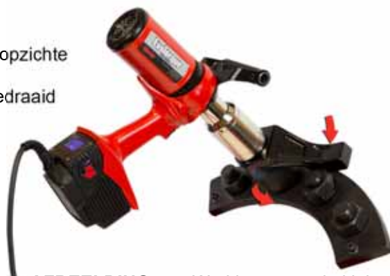
AFBEELDING 55 - Werking tegen de klok in
