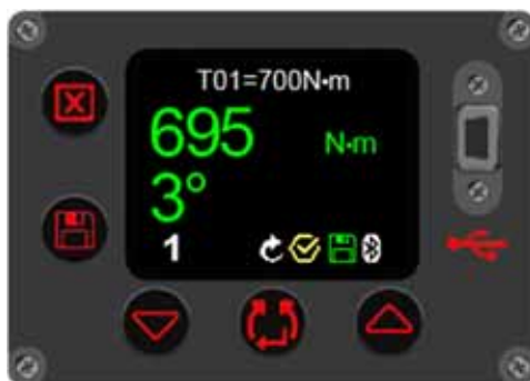
AFBEELDING 54 - Doelresultaat controlekoppel (weergegeven als bereikte koppel en (bout) beweging in graden)
