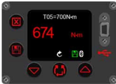
AFBEELDING 52 - Doelresultaat koppel (rood weergegeven voor Mislukt)
