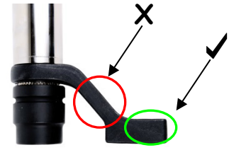
KUVA 2 – Taivutettu vastavoimavarsi (teräs tai alumiini)
