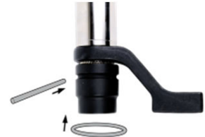
ILUSTRACIÓN 16 - Sujeción del dado
